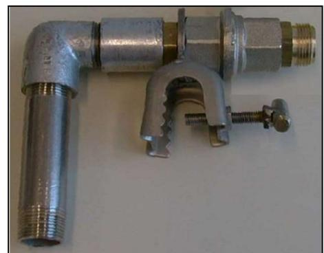
Bei Abfüllarbeiten mit größeren Zulaufschläuchen als die Füllöffnung des aufnehmenden Gefäßes es zulässt (z.B. DN 80-Schlauch zu DN 50-Öffnung), sind Reduzierstücke (*Beispiel siehe rechts*) zu verwenden. Solche Reduzierstücke sind ebenfalls betriebsintern herzustellen und zwecks Freigabegenehmigung der Abteilung SHE Prozesssicherheit vorzuführen.
