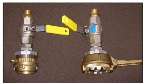
Solche Reduzierstücke unterliegen intern der wiederkehrenden Prüfung durch einen Sachkundigen.
