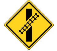
إشارة تقاطع طرق مع سكة حديدية غير خاضع للإشراف أمامك
