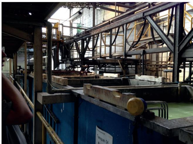
Figura 1 – Tanque com revestimento plástico e resistor (fonte: arquivo pessoal)
