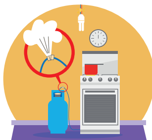
FUGA DE GAS
